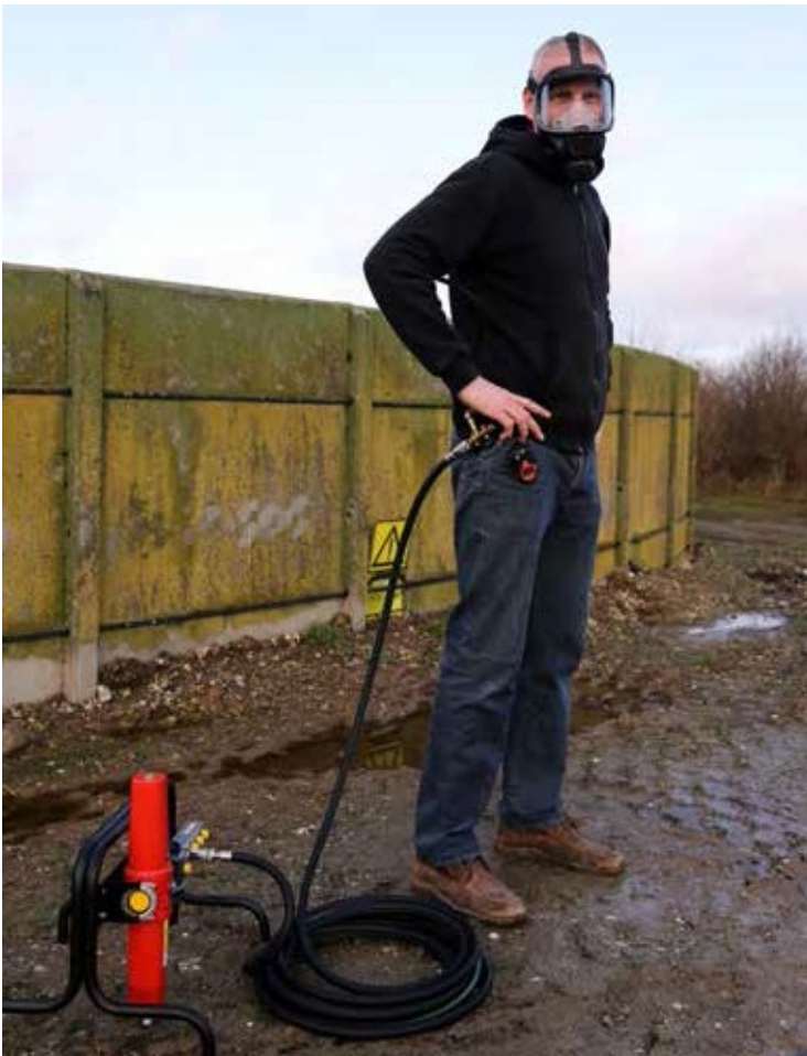
Luftforsyning åndedrætsværn, tilsluttes kompressor, så luften tilføres andetsteds fra. Bemærk, at der er tilsluttet filter for at rense luften
